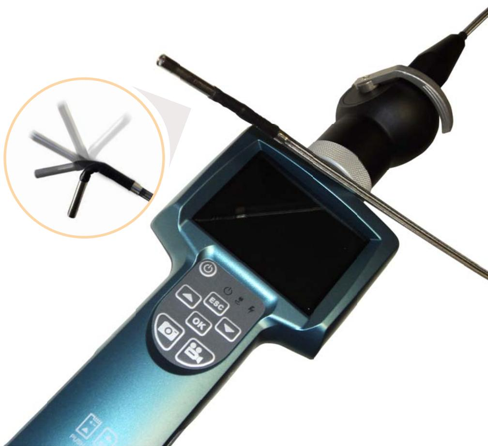
L'**Endoscam BQ** est un endoscope industriel dit béquillable. Sa tête 2 directions est articulable à distance par l'utilisateur via le joystick de la commande, permettant une visualisation complète et totale du volume inspecté.
